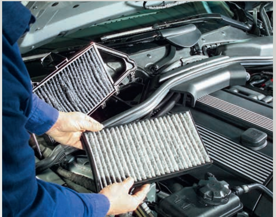
Fig. 1: Sustitución de un filtro de habitáculo
